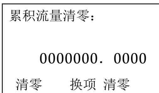
流量累积值清零，为了防止非法清空流量累积值或误操作，进入清零选项须输入密码。在密码检查界面，通过移位修改键输入正确密码，按下F2确认键，即进入清零界面，显示数值为当前累积流量值。在清零界面，为了防止误操作，
