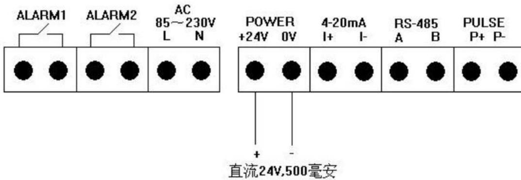
(2) 四线制4-20mA电流输出和HART手操器的接法:
