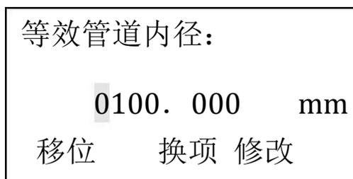
设置界面2：等效管道内径，设置仪表所测管道的内径，单位毫米。
