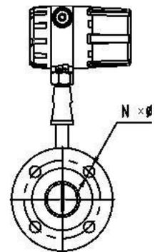
管段型热式气体质量流量计
